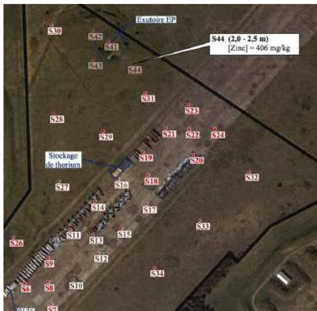
Figure 30 : Localisation sur vue aérienne de la teneur ponctuelle en zinc dans les sols de la piste allemande et valeurs de comparaison [HPC Envirotec, extrait annexe 5.2 de l'Annexe 4 - 3]
